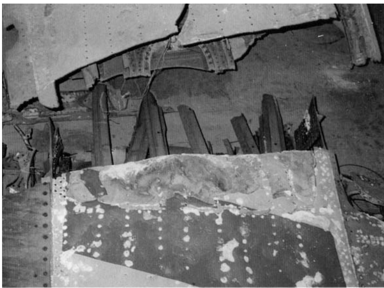
Zona di rottura dell'estremità dell'ala sinistra
